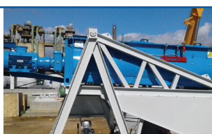
OPTIONAL Sistema basculante per Mixer Swinging system for Mixer
