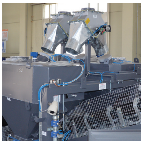
N.2 tramogge pesa cemento e polveri indipendenti N.2 independent weigh hoppers for cement and powders
