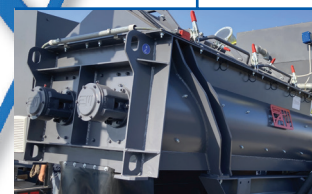
OPTIONAL Mescolatore comandato da Inverter Mixer controlled by Inverter
