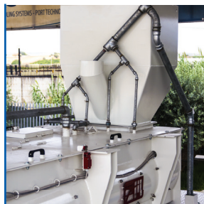
OPTIONAL Sistema di dosaggio Emulsioni Emulsion dosing system
